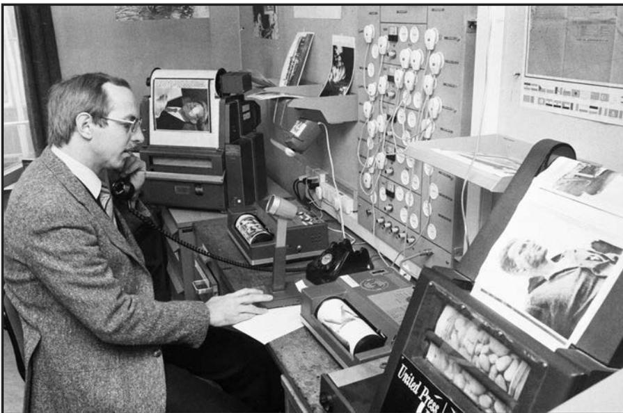
In der **1970er** Jahre revolutionierte der Bildfunk die Bildübertragung. Hier die Sende- und Empfangsanlage der Agentur Photopress. (Keystone/Photopress-Archiv/Str)
